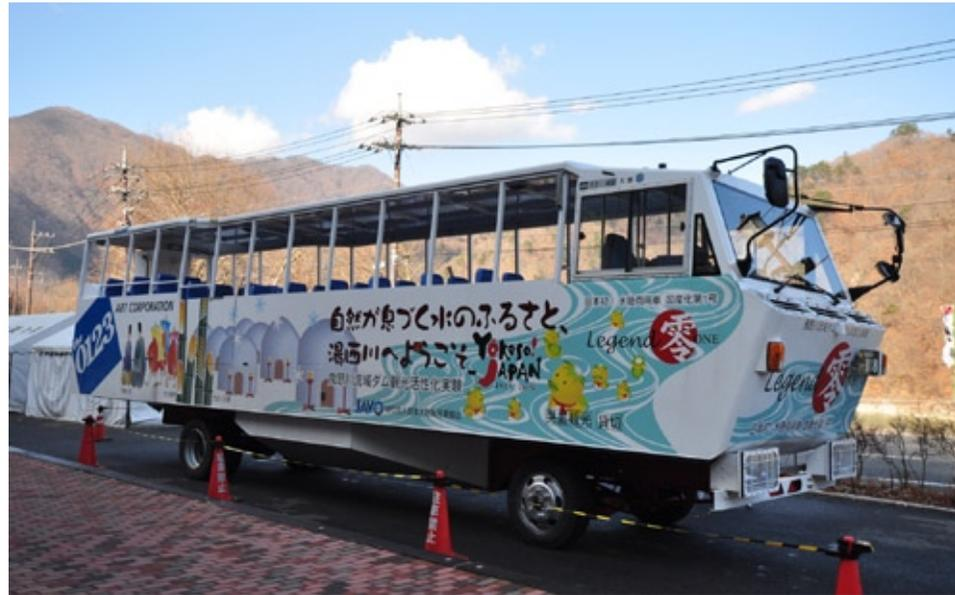
左下の写真が水陸両用バス「LEGEND 零 ONE号」。全長11.85m、全幅2.5m、全高3.65m。浮上走行時の噴水830mm、車両重量8680kg、乗車定員42名（乗員含む）というモノ。陸上走行時の最高速度は100km/hと、ふつうのバスに遜色ない性能をもちながらも、水上を15km/hのスピードで浮上走行することが出来ます。
